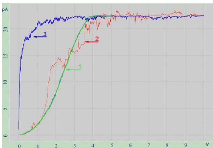
Рисунок 1. Качественное сравнение теоретической кривой 1 полевой зависимости вероятности 2d диссипативного туннельного переноса в рамках рассмотренной модели и экспериментальной ВАХ (кривая 2) растущей квантовой точки из коллоидного золота под иглой кантилевера АСМ/СТМ.
